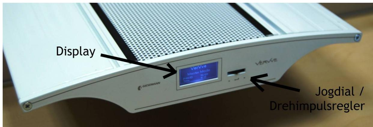
Halten Sie den Drehimpulsregler etwas länger gedrückt, um die Statusanzeige zu verlassen und das Hauptmenü der Steuerungsanzeige der Leuchte aufzurufen.
