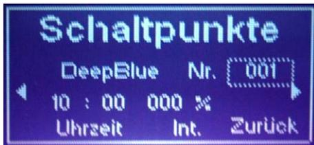
Das Display zeigt den ausgewählten Farbkanal, daneben die Nummer des aktuell gewählten Schaltpunktes, dessen Details (Uhrzeit mit Stunde und Minute, Helligkeit zu dieser Zeit in %) mit dem Drehimpulsschalter eingestellt werden können. Jeder Schaltpunkt erhält dabei eine genaue Schaltzeit und die zu dieser Zeit gewünschte Intensität. Eine einfache Kurve könnte beispielsweise allein aus vier Schaltpunkten nach folgendem Muster bestehen:
