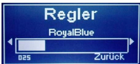
Die Auswahl des gewünschten Kanals erfolgt nach einem Tastendruck über den Drehimpulsschalter. Bestätigen Sie die Auswahl des gewählten Kanals erneut über einen Tastendruck und wechseln Sie danach in den darunter befindlichen Statusbalken, welcher zunächst auf 0% steht und daher vollkommen leer ist. Aktivieren Sie auch hier den Statusbalken durch einen Tastendruck, nun können Sie die Hellig-
