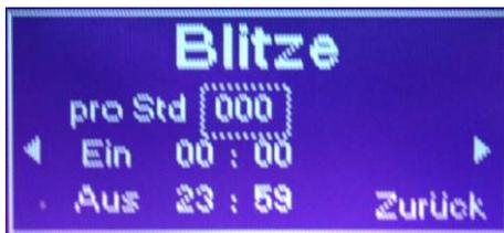
Die Details für das Ausführen von Blitzen können Sie unter „Einstellungen“ definieren. Hierfür geben Sie zunächst die Häufigkeit der Blitze (max. 180 Blitze pro Stunde) an. Zusätzlich stellen Sie mit einer Anfangs- und einer Endzeit das gewünschte Zeitfenster ein; Blitze werden dann mit der eingestellten Häufigkeit allein während dieser Periode ausgeführt.
