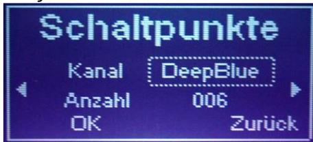
Die Anzahl der Schaltpunkte beim aktuell Gewählten Farbkanal kann nach einem Tastendruck durch Seitwärtsbewegung des Drehimpulsschalters einstellen und das Eingabefeld danach durch erneuten Tastendruck wieder verlassen. Eine einfache Tagesverlaufskurve lässt sich bereits mit wenigen Schaltpunkten definieren, für sehr individuelle Kurven können die bis zu 144 möglichen Punkte minutengenau pro Farbkanal gesetzt werden.
