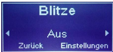
Zunächst können Sie einstellen, ob die Blitzsimulation der Leuchte ausgeführt werden soll. Mit einem Tastendruck können Sie die Einstellung jeweils im Wechsel „Ein“ beziehungsweise „Aus“ schalten.
