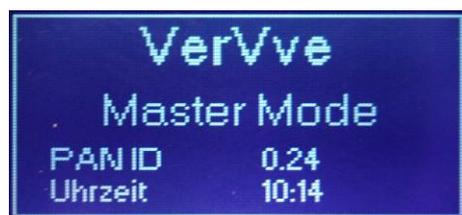
Für den gemeinsamen Betrieb mehrerer Leuchten ist eine eindeutige Netzkennung erforderlich. Dafür besitzt die Masterleuchte bereits bei der Auslieferung eine „**PAN-ID**“, deren Zahlenpaar das Leuchten-Netzwerk eindeutig kennzeichnet und das im Statusmenü dauerhaft angezeigt wird. Mehr zur Einrichtung des Netzbetriebs mit mehreren VERVve Leuchten finden Sie im Kapitel 9.1: „**Einrichtung des Netzwerks**“.
