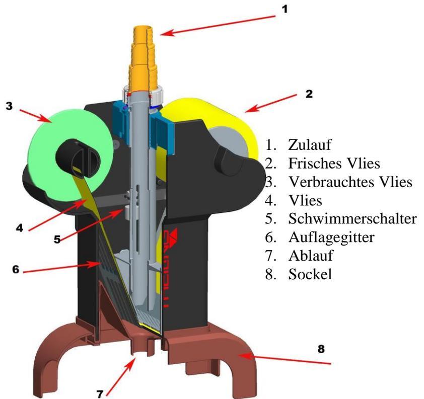
Das Vlies ist so fein, dass selbst sehr feine Verunreinigungen herausfiltriert werden. Dadurch wird der Schmutz aus dem Aquarium entfernt bevor er biologisch abgebaut wird. Das entlastet den Biofilter und im Meerwasser den Eiweißabschäumer.
