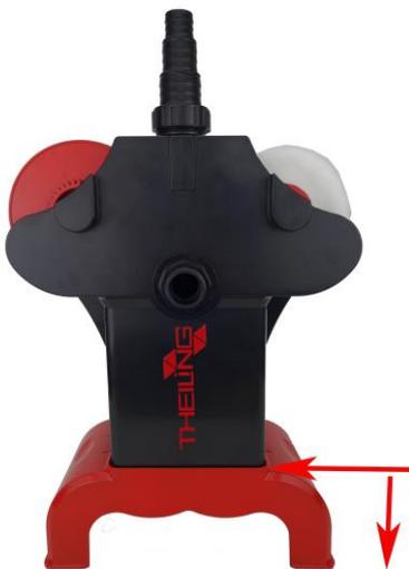
Zum Anschluss des RollerMat compact I wird ein Aquarium mit Überlaufschacht und Unterschrankfilterbecken benötigt. Der **RollerMat** kann bei Aquarien ins Filterbecken unter dem Aquarium gestellt werden. Er kann aber auch – ohne seinen Sockel – an eine senkrechte Scheibe angehängt werden. Immer muss darauf geachtet werden, dass der Wasserstand im Filterbecken bis maximal zum Sockel reicht. s. Abb. Das Motorabteil muss immer trocken bleiben.
