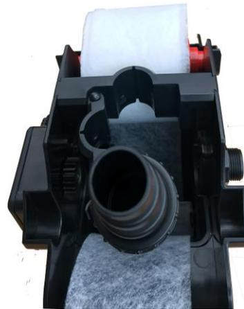
Das Ende wird festgehalten und die Zulaufverrohrung wieder eingebaut. Damit wird das Vlies bis nach unten gedrückt.
