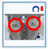
• Schieben Sie den blauen Sicherungsclip zwischen den Sicherungsring und den Anschluss. Testen Sie gleich danach ob der Schlauch fest sitzt. indem Sie an ihm ziehen.
