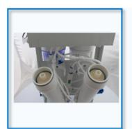
Setzen Sie die Membranen mit den 2 kleinen schwarzen Gummidichtungen zuerst in die Membrangehäuse ein und schieben Sie diese bis zum Anschlag durch.
