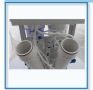
Öffnen Sie die Membrangehäuse und legen Sie den Deckel neben die Anlage.
