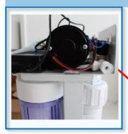
Entfernen Sie den transparenten Endstopfen und stecken Sie den Schlauch für die Wasserzufuhr in die Osmoseanlage.
