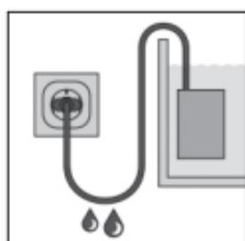
Diese verhindert, dass evtl. am Kabel entlang laufendes Wasser zur Steckdose gelangt und dadurch ein Kurzschluss verursacht wird.
