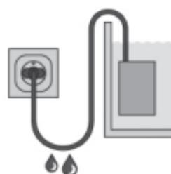
Det forhindrer, at vand, der muligvis løber langs ledningen, kommer ind i stikkontakten og dermed forårsager kortslutning.
