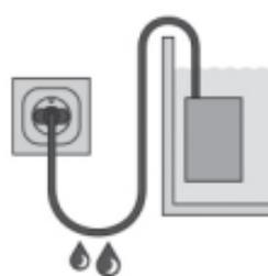
Это препятствует тому, чтобы вода, стекающая по кабелю, попадала в розетку и вызвала короткое замыкание.
