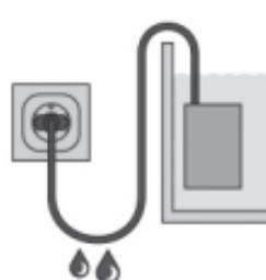
De este modo evitará que el agua pueda resbalar por el cable hasta la toma de corriente y provocar un cortocircuito.
